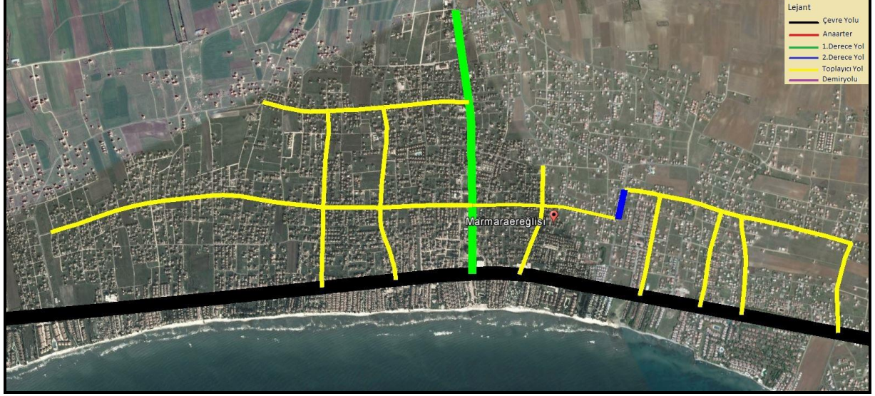
Şekil 5.9a. Yeniçiftlik yol kademelenmesi
