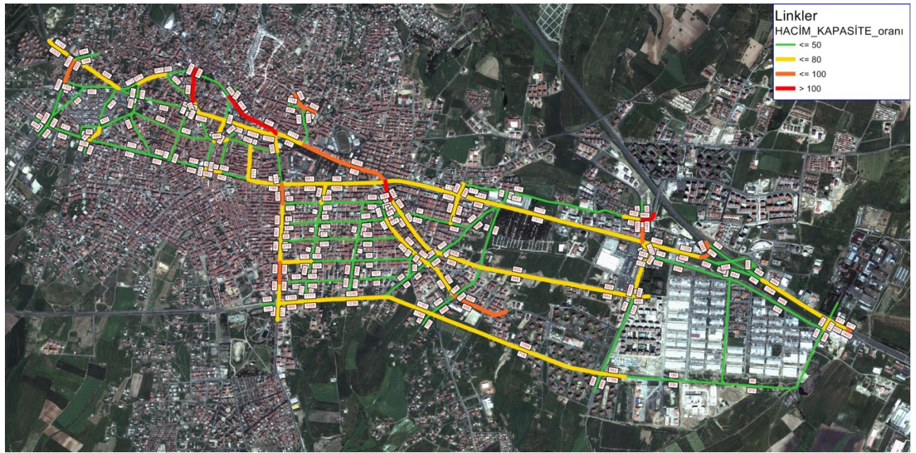
Şekil 3.4. Akşam zirve için modellenen ulaşım ağı performansı
